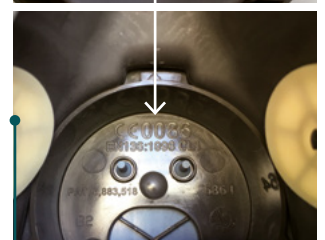
Fig. 6 — Exemplo de marcação de uma máscara completa.
